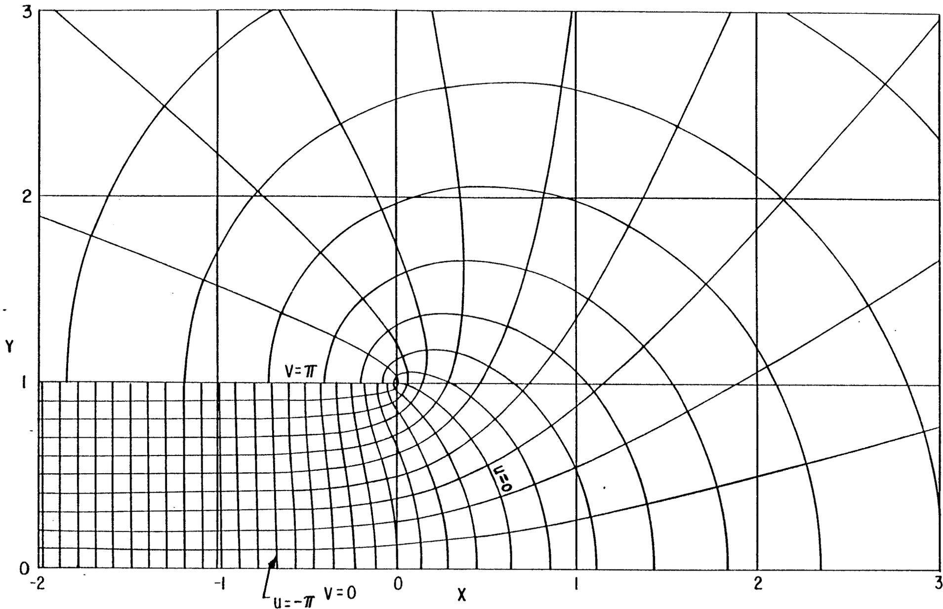
FIGURE 8. FIELD AND POTENTIAL DISTRIBUTION FOR SEMI-INFINITE, PARALLEL, TWO-PLATE TRANSMISSION LINE (UPPER HALF)
