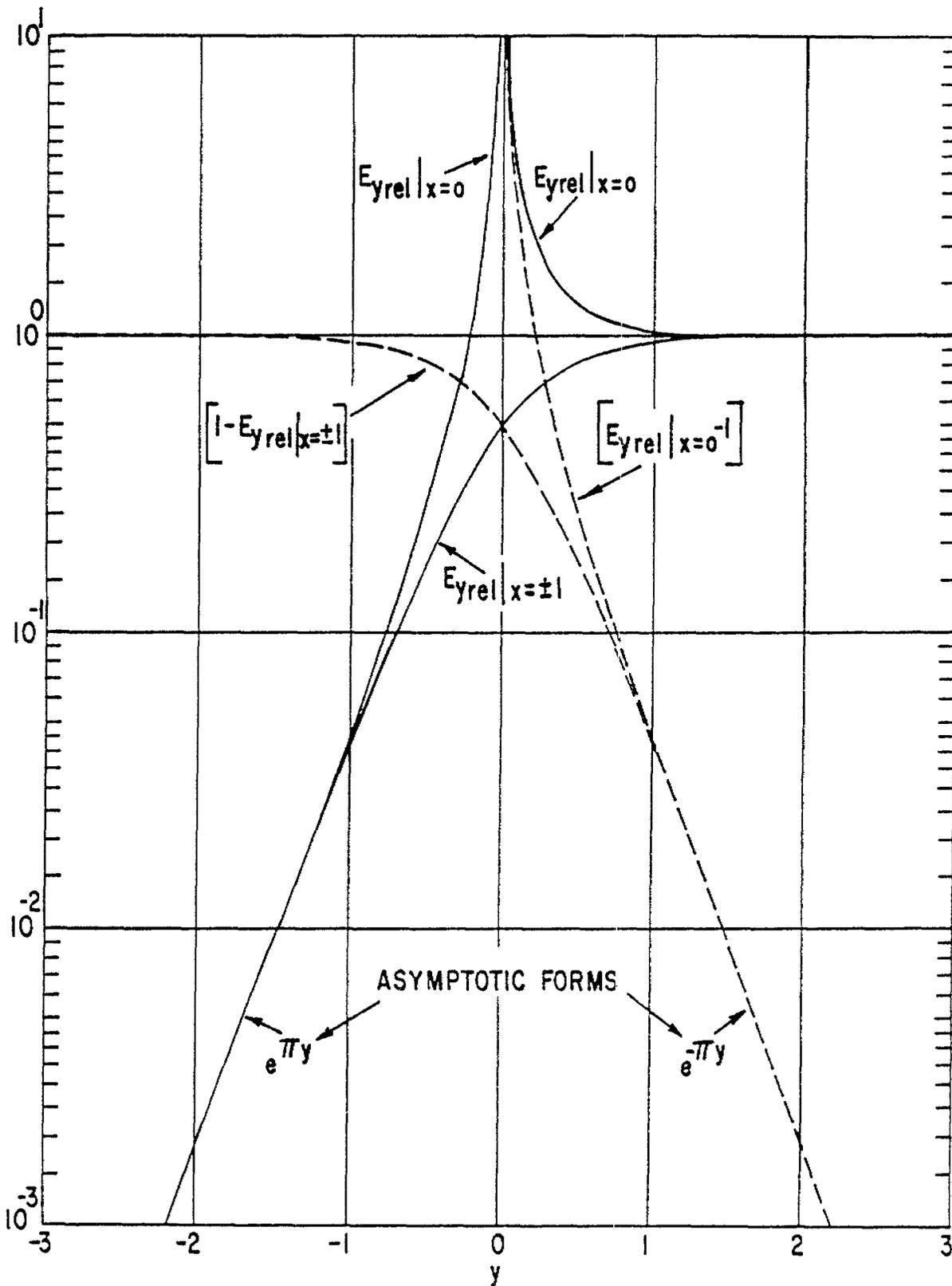
FIGURE 16. NORMALIZED FIELD DISTRIBUTION FOR WIRE GRID
