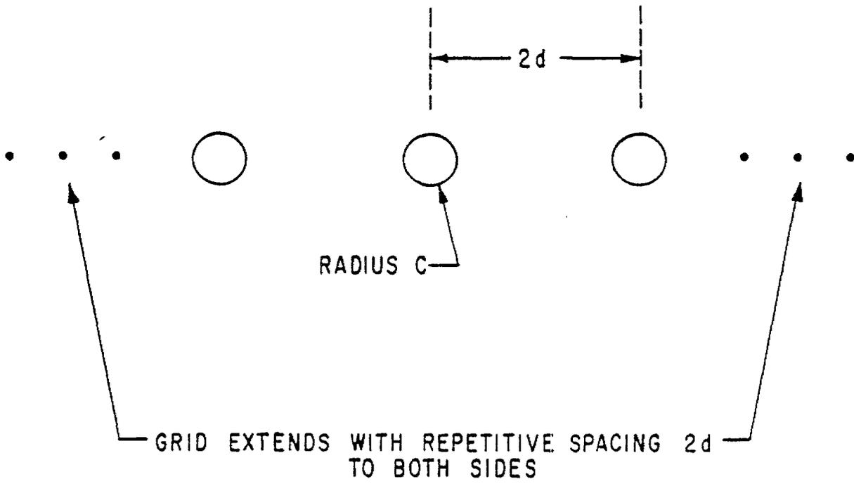
FIGURE 14. UNIFORM GRID OF PARALLEL WIRES
