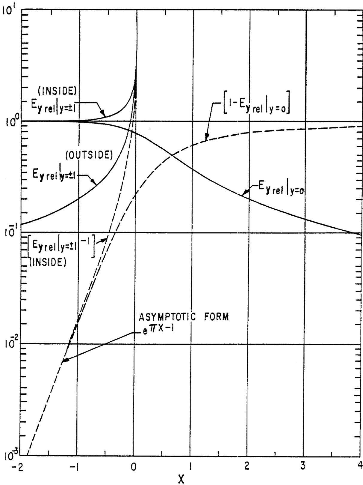
FIGURE 10. NORMALIZED FIELD DISTRIBUTION FOR SEMI-INFINITE, PARALLEL, TWO-PLATE TRANSMISSION LINE
