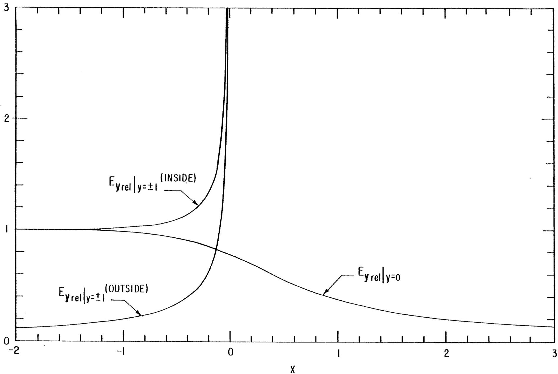
FIGURE 9. NORMALIZED FIELD DISTRIBUTION FOR SEMI-INFINITE, PARALLEL, TWO-PLATE TRANSMISSION LINE
