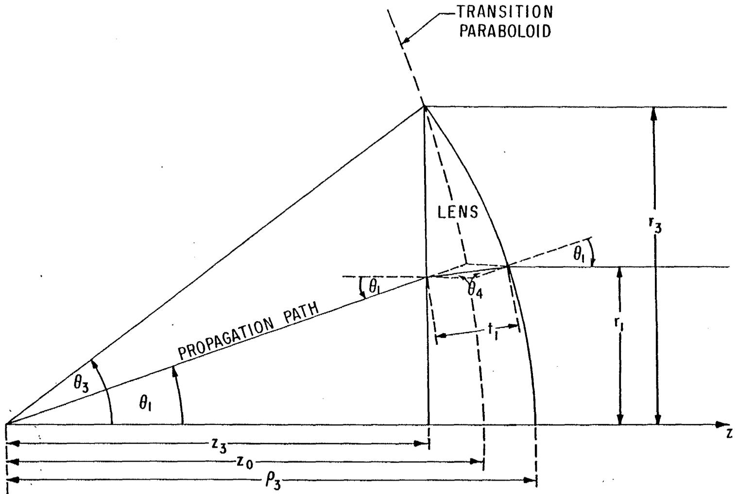
FIGURE 3. PLANO-CONVEX SYNTHETIC SPACE LENS
