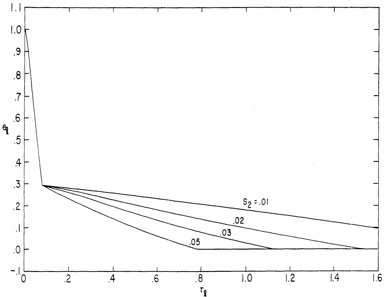
FIGURE 12. PULSE SHAPES FOR FINITE-LENGTH TRANSMISSION LINE
