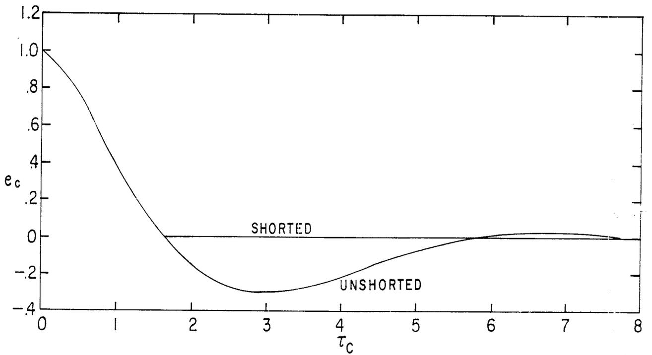
FIGURE 2. PULSE SHAPES FOR INFINITE-LENGTH TRANSMISSION LINE WITH ONE CAPACITOR
