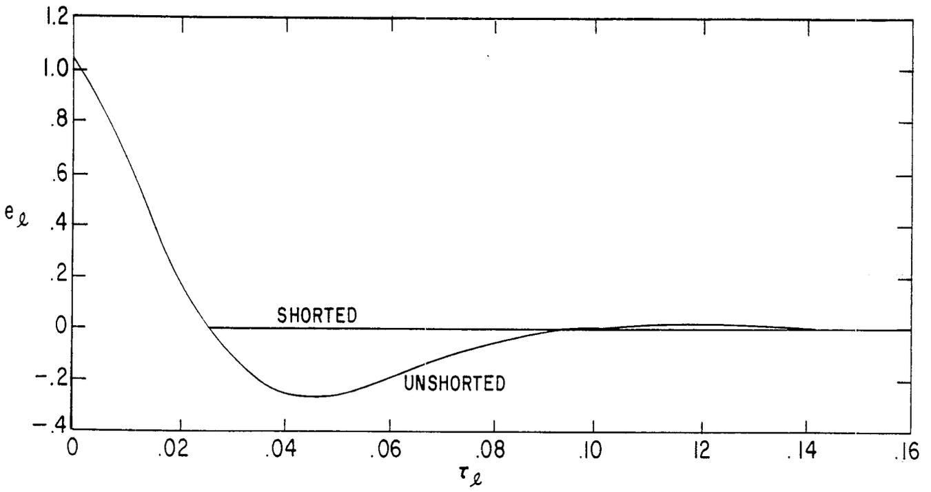
FIGURE 14. PULSE SHAPES FOR FINITE-LENGTH TRANSMISSION LINE WITH ONE CAPACITOR :  $\frac{t_0}{t_l} = .001$
