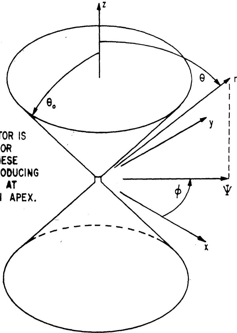
FIGURE 1. BICONICAL HIGH-FREQUENCY WAVE LAUNCHER
